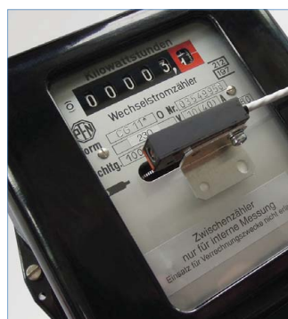
Scanner AFZ voor de Ferraris kWh-tellers
