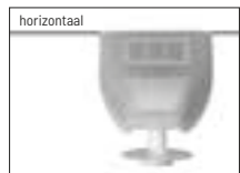
Afbeelding 3 Het weerstation moet in de dwarsrichting horizontaal gemonteerd worden.
