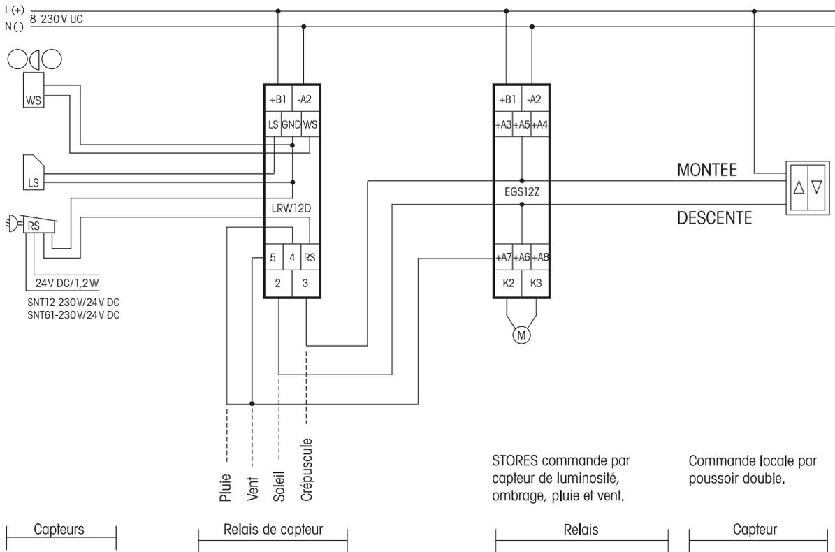
Dans le cas d'une commande avec 230V (+B1 = L, -A2 = N) les moteurs 230V sont raccordés directement aux bornes K2, K3 et N.
