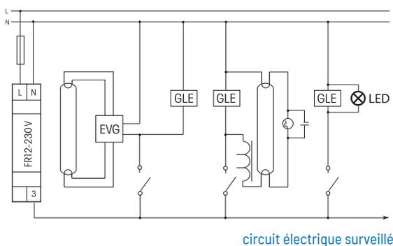
**Variateurs rotatifs anciens avec coupure en début de phase et charge ohmique** ou inductive peuvent en général être utilisés avec la tension de contrôle maximale  $V = \max$ , si il n'y pas d'autre charge en stand-by dans le circuit, sinon, se référer ci-dessous "télévariateur récent".
