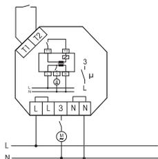
Raccordé à un contact de fenêtre (contact fermé si la fenêtre est ouverte) l'alimentation d'une hotte est enclenchée de telle façon que la hotte ne peut fonctionner que si la fenêtre reste ouverte.
