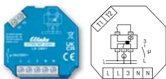
**Exemple de raccordement**
