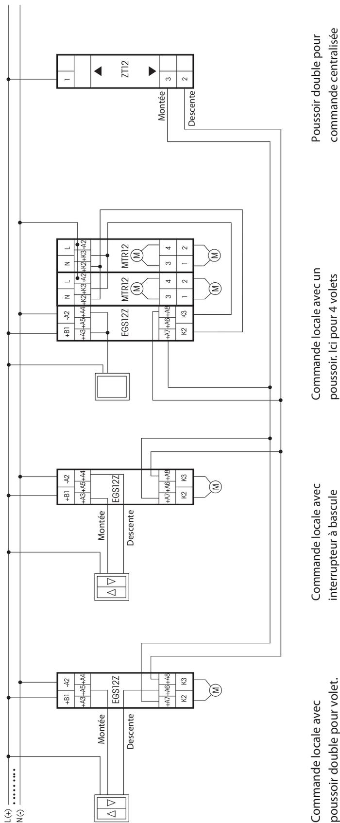
En utilisant **l'horloge de programmation hebdomadaire avec un contact inverseur** la commande de volet peut être automatisée en fonction du jour et de l'heure. Il faut pour cela que le contact inverseur soit programmé de telle façon que pendant la journée la borne +A3 soit raccordée avec L (+) et que pendant la nuit il inverse vers +A4. Toutes les autres entrées de commande restent actives pour la commande locale et la commande centralisée.
