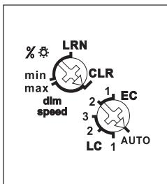
**Avec le commutateur supérieur rotatif %/dim speed**, on peut régler soit la valeur de luminosité minimale (variateur en position minimum) ou bien la vitesse de variation.
