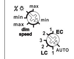
**Le commutateur supérieur %** permet de régler la luminosité minimale (diminuer au maximum) ou la luminosité maximale (diminuer au minimum). Avec le réglage de la vitesse de variation la durée de l'enclenchement et du déclenchement progressif est changé en même temps.
