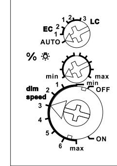
Derrière le commutateur supérieur se trouve une LED, qui indique une commande. Elle commence à clignoter après 15 secondes pour signaler un possible blocage d'un bouton-poussoir.
