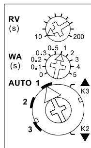
**AUTO 1** = Dans cette position de l'interrupteur inférieur la **fondction d'inversion confort pour jalousies** locale est **enclenchée**. Dans le cas de la commande locale avec un poussoir aux bornes A3+A4 (à ponter) ou d'un poussoir double aux bornes A5/A6 génère une impulsion double pour un enroulement lent dans le sens contraire et qui est arrêté après une autre impulsion.
