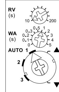
**AUTO 1** = dans cette position de l'interrupteur inférieur la **fondction d'inversion confortable pour jalosies locale est enclenchée**. Dans le cas de la commande locale avec un poussoir aux bornes A3+A4 (à pointer) ou d'un poussoir double aux bornes A5/A6 génère une impulsion double pour un enroulement lent dans le sens contraire et qui est arrêté après une autre impulsion.
