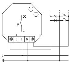
Circuit de raccordement à 3 fils, possibilité de réarmement (cumul)
