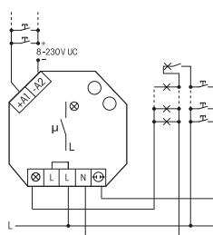
Circuit de raccordement à 4 fils, avec éclairage d'orientation au sol, possibilité de réarmement (cumul)
