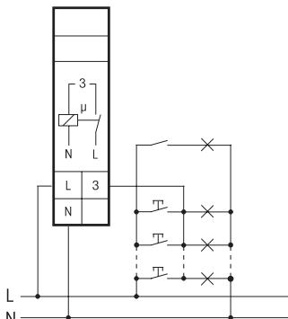
Circuit de raccordement à 3 fils,
