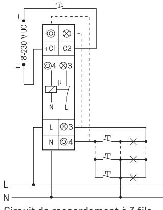
Circuit de raccordement à 3 fils, possibilité de réarmement (cumul)
