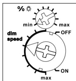
Con el selector % ⚡ se puede ajustar la luminosidad mínima (atenuado al mínimo).
