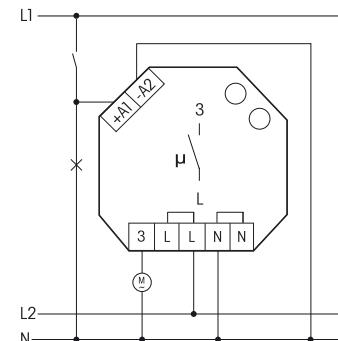
Control de un extractor sobre un interruptor de luz con potenciales diferentes al interruptor y extractor
