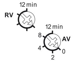
**Funcionamiento:** Con la conexión del contacto de control (interruptor de luz), empieza el retardo de conexión AV (si no está en posición 0), por el final del transcurso se conecta el extractor. Con la desconexión del contacto de control (interruptor de luz) y si el transcurso del retardo de conexión ha terminado, empieza el retardo de desconexión, al final del transcurso se desconecta el extractor.
