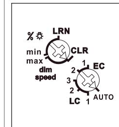
**Con el selector superior ☰/dim speed** se puede ajustar la luminosidad mínima (atenuado al mínimo) o la velocidad de la regulación.
