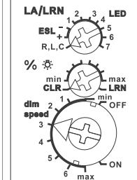
**El selector superior LA/LRN** se necesita primero para la asignación. En el funcionamiento, se configure el tipo de la carga a que tiene que ajustar la curva de atenuación, con este selector: La posición R,L,C es el ajuste para todas las cargas excepto LBC y LED, especialmente para lámparas incandescentes y halógenas de 230V. El tipo de las cargas, inductivas o capacítivas, se reconoce automáticamente.
