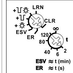
**Con el selector superior** en la posición LRN serán hasta 35 pulsadores inalámbricos memorizados, de estos uno o varios para el control centralizado. Además contactos inalámbricos de ventanas/puertas con la función NA o NC si la ventana está abierta, sensores inalámbricos exteriores de luminosidad FAH y detectores inalámbricos de movimientos FBH. Después se elige la función deseada del telerruptor-relé de conmutación:
