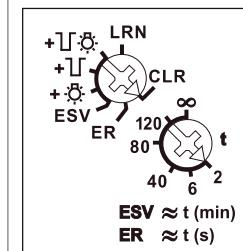
**Con el selector superior** en la posición LRN serán hasta 35 pulsadores inalámbricos memorizados, de estos uno o varios para el control centralizado. Además, contactos inalámbricos para puertas y ventanas con la función de contactos NA o NC si la ventana está abierta. Después se elige la función deseada del telerruptor-relé de conmutación:
