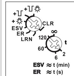
**Con el selector superior** en la posición LRN serán hasta 35 pulsadores inalámbricos memorizados, de estos uno o varios para el control centralizado. Además contactos de ventana puerta en la función contacto NA o NC, si la ventana está abierta. Después se elige la función del relé-telerruptor:
