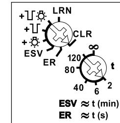
**Con el selector superior** en la posición LRN se pueden memorizar hasta 35 pulsadores de estos uno o varios para el control general. Además, contactos inalámbricos para puertas y ventanas con la función de contactos NA o NC si la ventana está abierta. Después se elige la función deseada del telerruptor-relé de conmutación:
