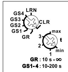
Con el selector superior se memoriza en la posición LRN hasta 35 pulsadores inalámbricos, de estos uno o varios como pulsadores del control centralizado. Después se elige la función deseada del telediáfragma con este selector:
