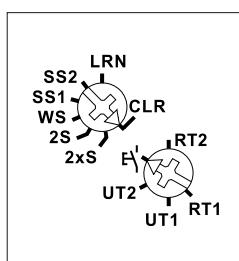
**Con el selector superior** se memoriza en la posición LRN hasta 35 pulsadores inalámbricos, de estos uno o varios como pulsadores del control centralizado. En continuación se elige con este selector la función deseada del telerruptor con multifunción. La conmutación se visualiza por un parpadeo del LED.
