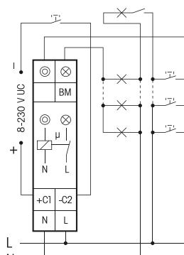
4-Leiter-Schaltung, mit Dachbodenbeleuchtung, nachschaltbar.
