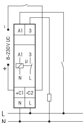
\* Die maximale Last kann ab einer Verzögerungs- oder Taktzeit von 5 Minuten genutzt werden. Bei kürzeren Zeiten reduziert sich die maximale Last wie folgt: Bis 2 Sekunden auf 15%, bis 2 Minuten auf 30%, bis 5 Minuten auf 60%.
