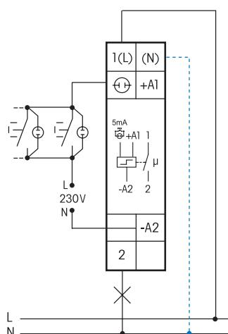
Bei angeschlossenem N ist die Kontaktierung im Nulldurchgang aktiv.
