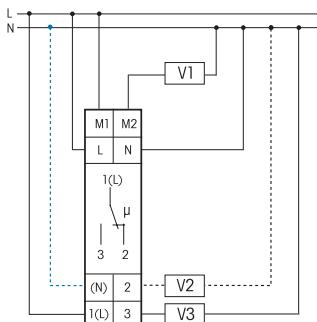
Bei angeschlossenem N ist die Kontaktierung im Nulldurchgang aktiv.
