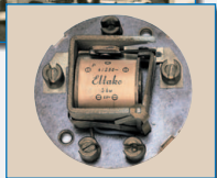
Einer unserer ersten Stromstoßschalter
