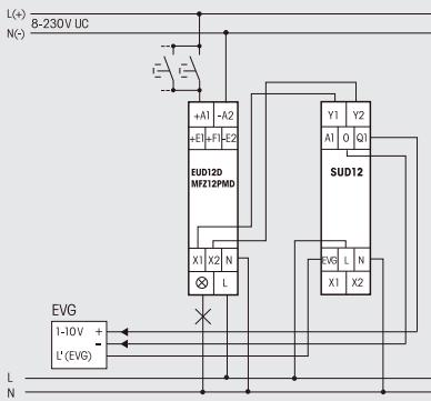
In dieser Schaltungsart können, in Verbindung mit einem Universal-Dimmschalter EUD12D bzw. MFZ12PMD, elektronische Vorschaltgeräte und Trafos mit einer 1-10V-Schnittstelle bis zu 40 mA Gesamt-Steuerstrom angesteuert werden.
