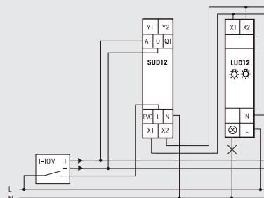
In dieser Schaltungsart kann, in Verbindung mit einem an die Anschlüsse X1/X2 angeschlossenen Leistungszusatz LUD12, der Ausgang eines 1-10V-Steuengerätes an A1/O in eine direkte Dimmfunktion umgesetzt werden. Das Ein- und Ausschalten erfolgt ebenfalls extern an L des SUD12.
