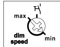
**Mit dem dim speed-Drehschalter (nur bei Ansteuerung mit Taster)** kann die Dimmgeschwindigkeit eingestellt werden.
