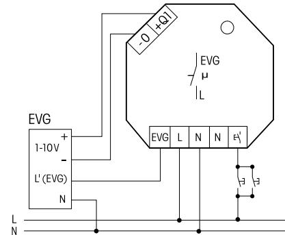
Zur Ansteuerung mehrerer LED-Konverter mit passiver 1-10 V Schnittstelle ist eine zusätzliche Hilfsspannung von 12 V DC erforderlich, diese kann mit einem Weitbereichschaltnetzteil WNT15-12VDC/24W bzw. WNT61-12VDC/10W zur Verfügung gestellt werden. Des Weiteren wird ein 1kOhm Widerstand benötigt.
