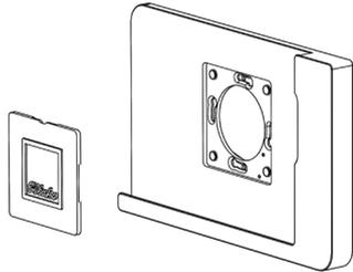
2. Entfernen Sie die hintere Montageabdeckung.
