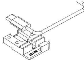
4. Legen Sie nun die Führungsstange ein und schrauben Sie das Oberteil der Steckerhalterung mit den zwei mitgelieferten Schrauben auf das Unterteil der Steckerhalterung. Je stärker Sie die Schrauben anziehen, umso schwieriger lässt sich die Steckerhalterung auf der Führungsstange verschieben. Zusätzlich kann über den mitgelieferten Inbusschlüssel die Höhe des USB-C Steckers bei Bedarf angepasst werden.
