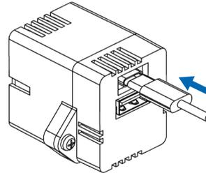
7. Schrauben Sie die OnWall/2 mit zwei passenden Schrauben auf der Elektronikdose fest. Hierzu können die mitgelieferten 3x20 mm-Schrauben verwendet werden. Achten Sie dabei darauf, dass das USB-C Ladekabel nicht eingeklemmt wird.
