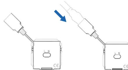
2. Stecken Sie das USB-Flachbandkabel der OnWall in die USB-A-Buchse des Netzteils.
