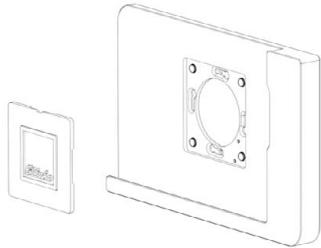
1. Entfernen Sie die Montageabdeckung von der Magnethalterung.
