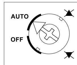
Mit einem Drehschalter können die Funktionen 'Auf' oder 'Ab' gesperrt werden und kann ganz ausgeschaltet werden. Diese Sperre gilt nur für die max. 2 angeschlossenen Motoren. Damit können einzelne Beschattungselemente oder Rolladen von der Automatikfunktion einer Gesamtsteuerung ganz oder teilweise ausgenommen werden.
