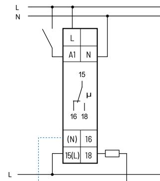
Bei angeschlossenem (N) ist die Kontaktierung im Nulldurchgang aktiv.
