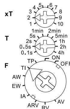
**Die Leuchtdiode** unter dem großen Drehschalter informiert während des Zeitallaufes über die Kontaktstellung. Sie blinkt, solange der Arbeitskontakt 15-18 offen ist (15-16 geschlossen) und leuchtet ständig, solange der Arbeitskontakt 15-18 geschlossen (15-16 offen) ist.
