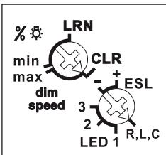
**Mit dem %/dim speed-Drehschalter** kann entweder die Mindesthelligkeit (voll abgedimmt) oder die Dimmgeschwindigkeit eingestellt werden. In der Stellung LRN werden bis zu 35 Funktaster zugeordnet, davon ein oder mehrere Zentralsteuerungs-Taster.
