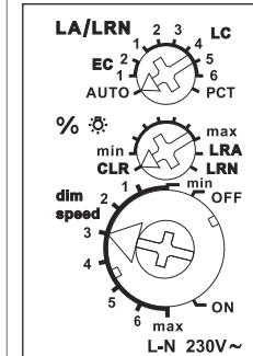
Der obere Drehschalter LA/LRN wird zunächst zum Einlernen benötigt und legt im Betrieb fest, ob die automatische Lampenerkennung wirken soll, oder spezielle Comfort-Stellungen:
