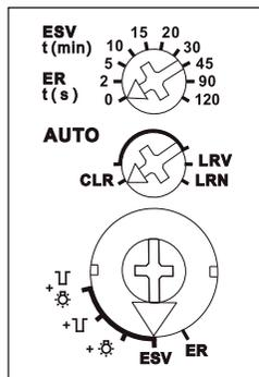
Mit dem unteren Dreheschalter wird die Funktion des Aktors eingestellt.
