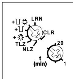
**Mit dem oberen Drehschalter** werden in der Stellung LRN bis zu 35 Funktaster und/oder Bewegungs-Helligkeitssensoren FBH zugeordnet, davon ein oder mehrere Zentralsteuerungs-Taster. Danach wird damit die gewünschte Funktion dieses Treppenlicht-Nachlaufschalters gewählt.
