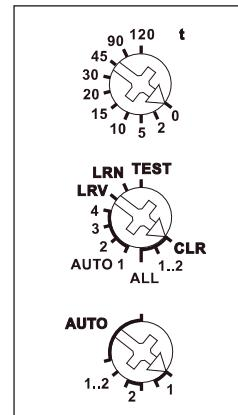
**Mit den Drehschaltern** werden die Taster eingelernt und gegebenenfalls die 2 Kanäle getestet. Für den Normalbetrieb werden
