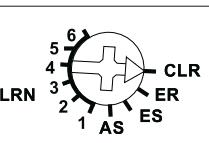
**Mit dem Drehschalter auf der Seite** werden in den Stellungen LRN bis zu 35 Funktaster zugeordnet, davon ein oder mehrere Zentralsteuerungs-Taster. Außerdem ein Funk-Bewegungs-Helligkeitssensor FBH und/oder ein Funk-Außen-Helligkeitssensor FAH für eine Anwesenheits-Simulation. Danach wird damit die gewünschte Funktion dieses Stromstoß-Schaltrelais gewählt:
