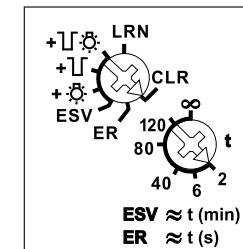
**Mit dem oberen Drehschalter** werden in der Stellung LRN bis zu 35 Funktaster zugeordnet, davon ein oder mehrere Zentralsteuerungs-Taster. Außerdem Funk-Fenster-Türkontakte mit der Funktion Schließer oder Öffner bei geöffnetem Fenster, Funk-Helligkeitssensoren und Funk-Bewegungsmelder. Danach wird damit die gewünschte Funktion dieses Stromstoß-Schaltrelais gewählt:
