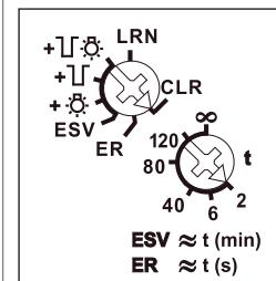
**Mit dem oberen Drehschalter** werden in der Stellung LRN bis zu 35 Funktaster zugeordnet, davon ein oder mehrere Zentralsteuerungs-Taster. Außerdem Funk-Fenster-Türkontakte mit der Funktion Schließer oder Öffner bei geöffnetem Fenster, Funk-Außen-Helligkeitssensoren FAH und Funk-Bewegungsmelder FBH. Danach wird damit die gewünschte Funktion dieses Stromstoß-Schaltrelais gewählt:
