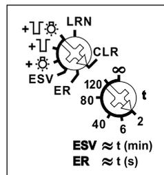
**Mit dem oberen Drehschalter** werden in der Stellung LRN bis zu 35 Funktaster zugeordnet, davon ein oder mehrere Zentralsteuerungs-Taster. Außerdem Funk-Fenster-Türkontakte mit der Funktion Schließer oder Öffner bei geöffnetem Fenster, Funk-Außen-Helligkeitssensoren FAH und Funk-Bewegungsmelder FBH. Danach wird damit die gewünschte Funktion dieses Stromstoß-Schaltrelais gewählt:
