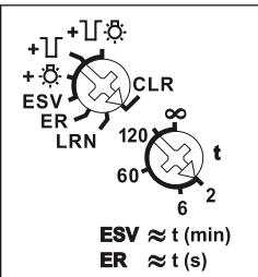
**Mit dem oberen Drehschalter** werden in der Stellung LRN bis zu 35 Funktaster zugeordnet, davon ein oder mehrere Zentralsteuerungs-Taster. Außerdem Funk-Fenster-Türkontakte mit der Funktion Schließer oder Öffner bei geöffnetem Fenster. Danach wird damit die gewünschte Funktion dieses Stromstoß-Schaltrelais gewählt:
