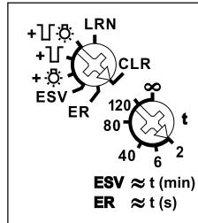
**Mit dem oberen Drehschalter** werden in der Stellung LRN bis zu 35 Funktaster zugeordnet, davon ein oder mehrere Zentralsteuerungs-Taster. Außerdem Funk-Fenster-Türkontakte mit der Funktion Schließer oder Öffner bei geöffnetem Fenster. Danach wird damit die gewünschte Funktion dieses Stromstoß-Schaltrelais gewählt:
