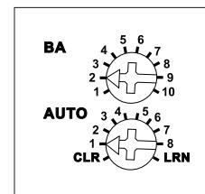
Der Drehschalter wird für die Aktivierung bzw. Deaktivierung der Verschlüsselung benötigt und steht im Betrieb auf AUTO.
