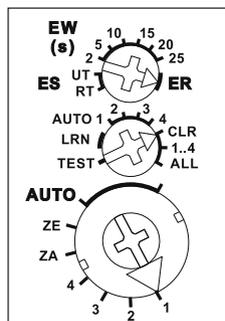
Mit dem oberen Drehschalter wird die Funktion der 4 Kanäle gemeinsam als Stromstoßschalter mit Universaltaster (ES-UT), als Stromstoßschalter mit Richtungstaster (ES-RT), als Einschaltwischer (EW) oder als Relais (ER) definiert. In der Funktion ES können Zentralsteuerbefehle Ein/Aus eingelernt werden. In der Funktion EW kann die Wischzeit zwischen 2 und 25 Sekunden eingestellt werden.
