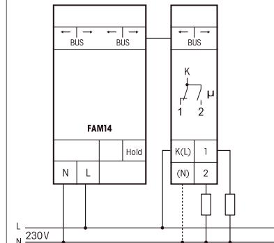
Multifunktions-Zeitrelais mit 10 Funktionen, 1 Wechsler potenzialfrei 10A/250V AC, Glühlampen 2000W\*, mit DX-Technologie. Bidirektional. Stand-by-Verlust nur 0,4 Watt. Reiheneinbaugerät für Montage auf Tragschiene DIN-EN 60715 TH35.
