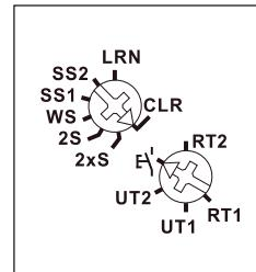
**Mit dem oberen Drehschalter** werden in der Stellung LRN bis zu 35 Funktaster zugeordnet, davon ein oder mehrere Zentralsteuerungs-Taster. Danach wird damit die gewünschte Funktion dieses Multifunktions-Stromstoßschalters gewählt. Die Umschaltung wird visualisiert durch LED-Aufblitzen.
