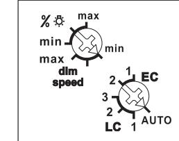
**Mit dem oberen %/dim speed-Drehschalter** kann entweder die Dimmgeschwindigkeit eingestellt werden oder die Mindesthelligkeit (voll abgedimmt). Mit der Dimmgeschwindigkeit wird auch die Dauer von Soft-Ein und Soft-Aus verändert.
