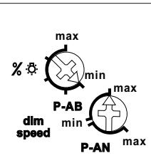
**Mit dem oberen %-%-Drehschalter** kann die Mindesthelligkeit (voll abgedimmt) eingestellt werden.
